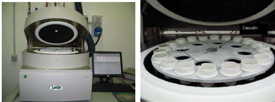
Fig. 2. -Analizzatore termogravimetrico LECO TGA-701
