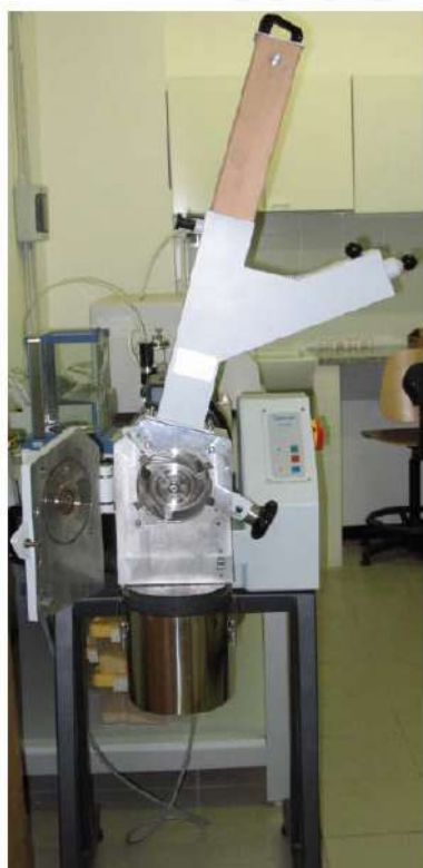
Fig. 1 - Mulino a lame RESTCH modello SM 2000
