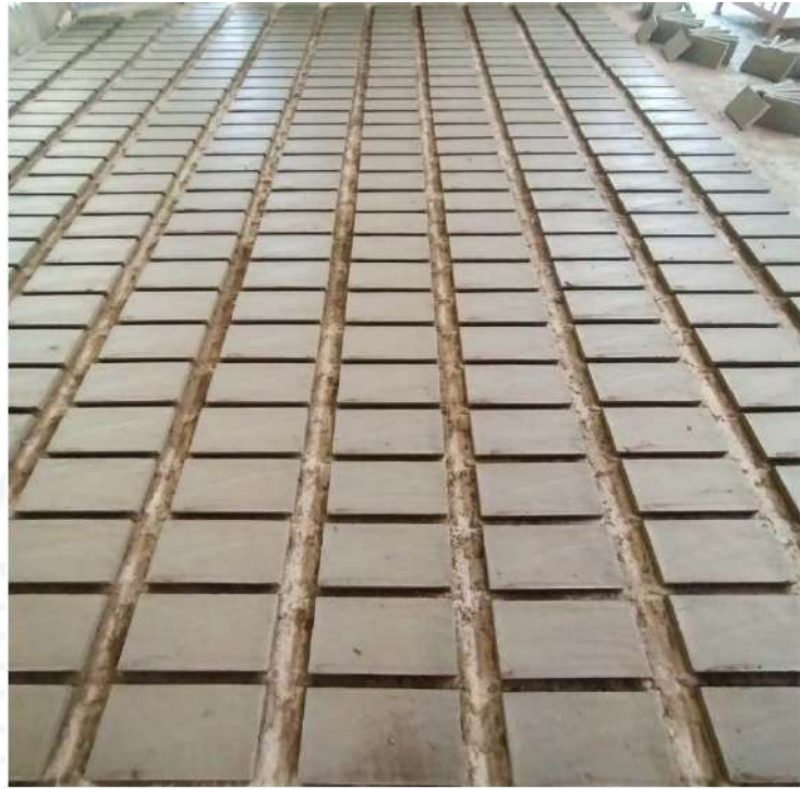
Fig. 14 - Laterizi lavorati a mano in fase di preparazione per la “cotta”
