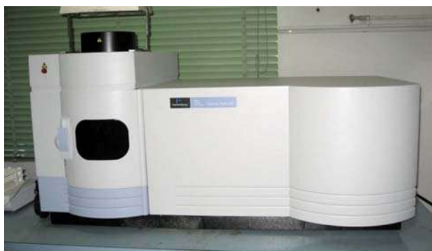
Figura 4 - ICP OES Optima 8000 Perkin Elmer con autocampionatore AS 40
